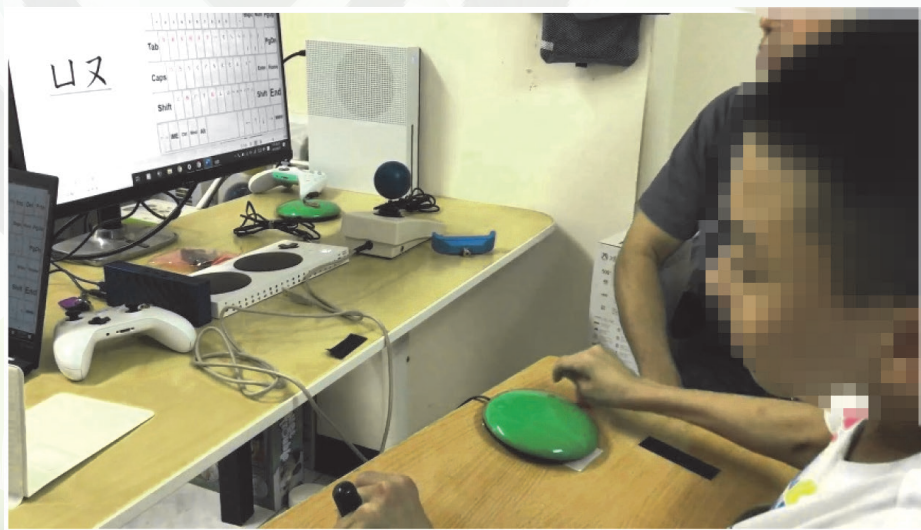
圖10、操作範例：以特殊開關取代滑鼠功能，使用螢幕鍵盤軟體，進行文字輸出。
