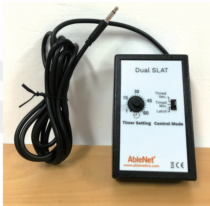
圖8、Ablenet dual switch & timer按鍵功能模擬器
