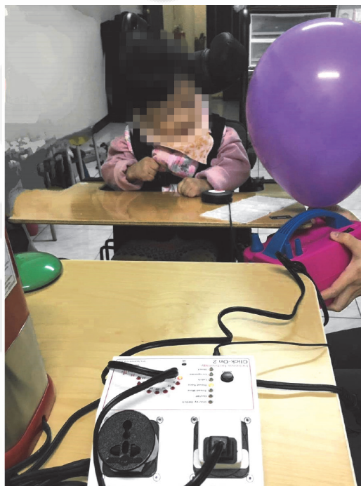
圖2、操作範例：以特殊開關結合電源控制設備連接打氣機，進行充氣。
