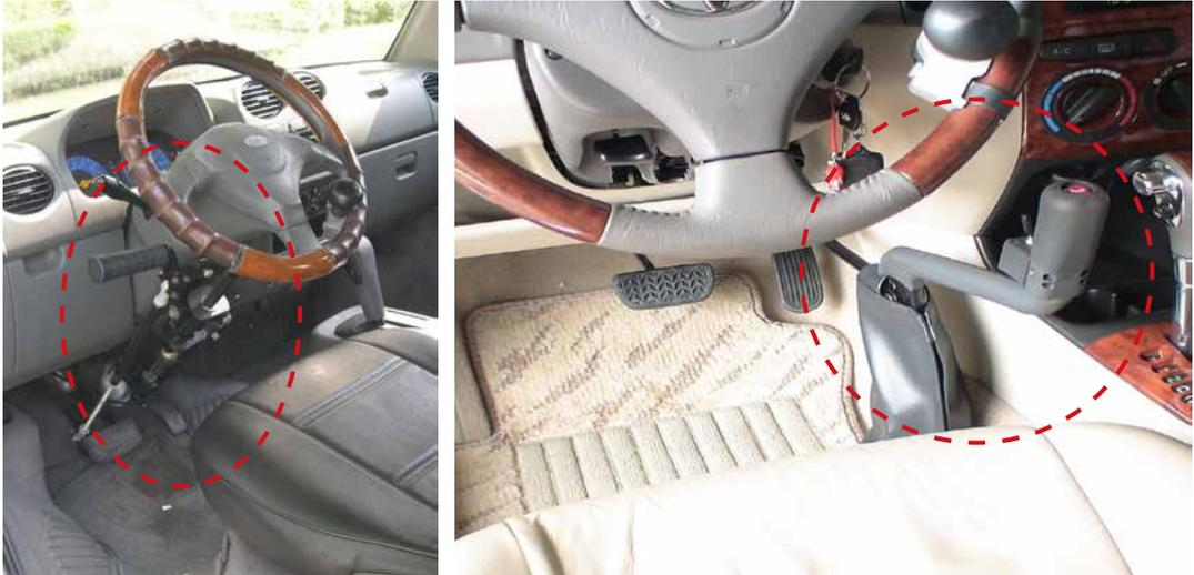
圖 1. 推 - 直角 - 拉式油門剎車連桿 圖 2. 推 - 拉式油門剎車連桿
