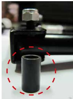
如剎車中心點之襯套磨損時，建議回原裝修點更換。
